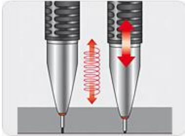
La mina del portaminas se amortigua, protegiéndola de la rotura.
